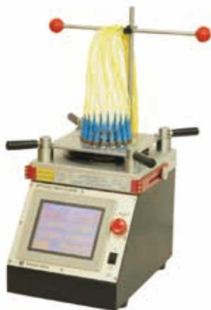
量産汎用性と作業性を兼ね備えた、550シリーズの新型最上級モデルです。タッチパネル方式で簡単操作を実現、多種多様なコネクタの研磨工程のプログラム入力ができます。スロースタート機能のほか、各工程ごとのターンテーブル回転速度調節も可能、ユニバーサル電源の採用で世界のどこでも変圧器なしで使用可能です。また550S2から新たに採用された、研磨時間自動調整機能は踏襲され、研磨形状の均一化とフィルム寿命の向上に寄与します。従来のモデルに比べ、メンテナンス性・耐久性の向上を図り、メンテナンスコストの削減に寄与します（当社比1/10減）。
