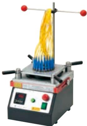
量産汎用性をそのままに必要な機能を残し、コストパフォーマンスを実現した550シリーズの新型ベーシックモデルです。従来のモデルに比べメンテナンス性・耐久性の向上を図り、メンテナンスコストの削減に寄与します（当社比1/10減）。また研磨スピードも従来機に比べハイスピードタイプとなり当社比約20%の生産性向上を図っております。研磨ホルダは、従来の550(120A)シリーズ用のホルダをご使用頂けます。当社研磨ホルダの特徴は個々のフェルールに荷重を加える（IPC方式）を採用し、フェルール突き出し長のバラツキに影響されない高精度な研磨特性が得られます。複数の研磨機と研磨ホルダを工程毎に設置する事で大規模なコネクタ研磨ラインを確立できます。
