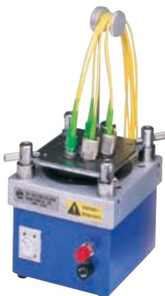
比較的少量の生産に適したタイプで、SFP-70Dは6軸の最大同時研磨が可能です。フィールドでの使用も考慮し、DC電源での動作が可能です。研磨機の機構、構造はSFP-550Cと同じであるため、スケールアップの際の移行もスムーズに行えます。
