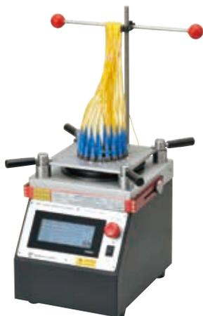
研磨工程プログラム機能を備えた550シリーズの中級モデルです。従来のモデルは、4つの独立したタイマーを備えておりましたが、SFP-550E3は、タッチパネル上で4つのマルチタイマーを実現しております。また新たに、研磨プロセスのプログラム機能も追加されました（8ステップ×12プロセス）。研磨スピードは、公転スピードが70回転から200回の間で調整が可能です。自転は公転スピードに追従し自動調整されます。またオプションの中央加圧モジュールを装着することで、最新の多心コネクタ用研磨機として使用出来ます。従来のモデルに比べ、メンテナンス性・耐久性の向上を図り、メンテナンスコストの削減に寄与します（当社比1/10減）。
