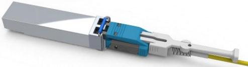
※トランシーバーのLCコネクタ嵌合口に大きなバリなどがあることで着脱ツールを使って取り外しが適切に行えない場合、着脱ツール以外の方法で取り外しをされることを推奨します。
