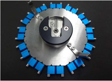
φ1.25フェールV溝研磨治具 24軸
