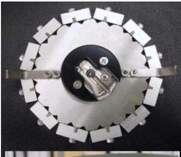
φ2.5フェールルV溝簡易SC研磨治具 24軸
