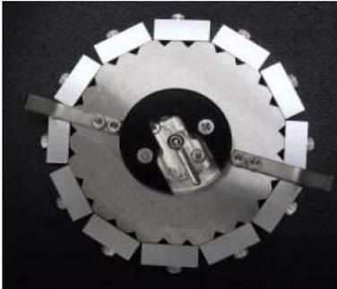
φ2.5フェールルV溝SC研磨治具 24軸
