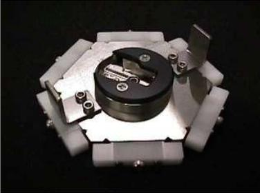
φ2.5フェールルV溝研磨治具 12軸
