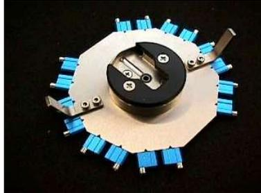
φ1.25フェールV溝研磨治具 16軸
