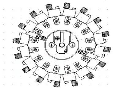
φ2.57エルール8度V溝研磨治具 16軸
