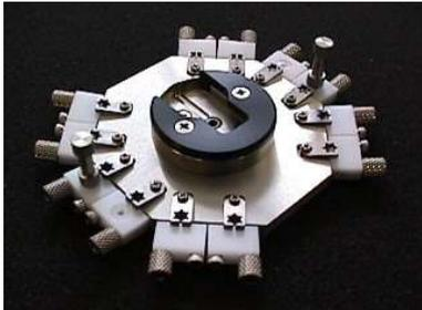
E2000セラフランジ8度研磨治具 12軸
