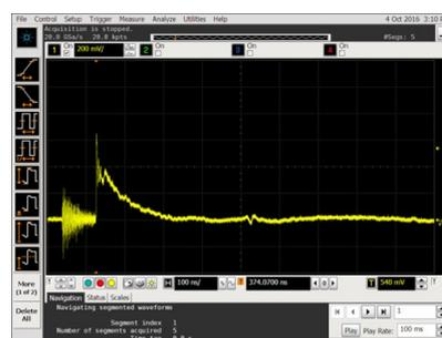
③ 接触電圧計測 制御 IC ピンへのノイズ電圧を直接測定
